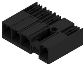
Однорядный сильноточный высокоэффективный штекерный соединитель для поэтапного монтажа без ущерба для полюсов или с использованием запатентованного фланца для обеспечения быстрой фиксации без использования инструментов. Максимальная надежность при соединении и работе благодаря прилегающему профилю, которые предотвращает неправильное соединение с уникальным разнообразием кодировки и дополнительным креплением во фланце.
