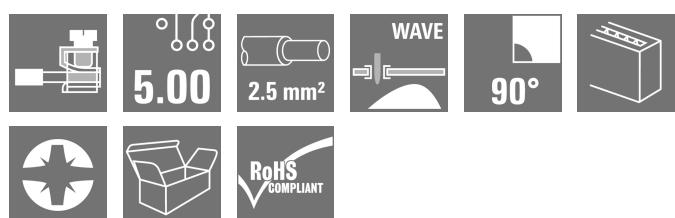
Клемма для печатной платы с соединением с плоской пружиной и шагом 5,00 и 5,08 мм. Направление вывода проводов: 90°. Для проводов сечением до 2,5 мм<sup>2</sup>.
