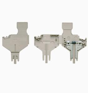
Компонентный штекер служит для интеграции электрического компонента в расцепляющий клеммный блок. После пайки электронного компонента вставку можно интегрировать в расцепляющую зону расцепляющих клеммных блоков, тем самым преобразуя расцепляющий клеммный блок в модульный клеммный блок с интегрированным электронным компонентом.
