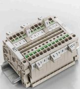
Держатель маркировочных элементов обеспечивает возможность дополнительной установки стандартных маркеров с шагом 5 или 5,1 мм. Угловые держатели могут быть дополнительно комбинированы и установлены во всех маркировочных каналах модульных клеммных колодок Klippon®. Типы установочных маркеров можно найти под соответствующими принадлежностями специального держателя маркировочных элементов.
