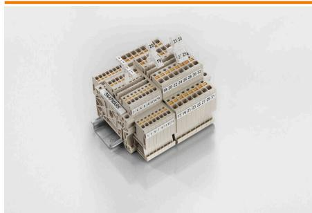
Держатель этикеток SnapMark разработан специально для двухуровневых клемм IDK 1.5N серии I. Гибкий поворотный механизм обеспечивает удобство установки и извлечения перемычек. Возможность прикрепления четырех маркировочных этикеток DEK 5 или двух маркировочных элементов для разъемов WS 10/5 Middle.
