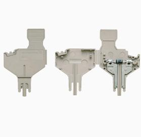
Компонентный штекер служит для интеграции электрического компонента в расцепляющий клеммный блок. После пайки электронного компонента вставку можно интегрировать в расцепляющую зону расцепляющих клеммных блоков, тем самым преобразуя расцепляющий клеммный блок в модульный клеммный блок с интегрированным электронным компонентом.
