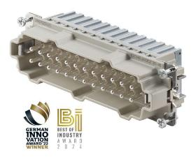
При использовании быстроразъемного соединения SNAP IN уровень соединения проводов уже открыт, и можно просто вставить очищенный провод. В конечном положении запатентованный фиксирующий механизм закроется автоматически. Благодаря этому техническое облуживание практически не требуется, и обеспечивается безопасное, долговременное и защищенное от вибрации соединение. Таким образом, компания Weidmüller является первым и единственным производителем, предлагающим эту инновационную систему соединений.
