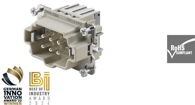
При использовании быстроразъемного соединения SNAP IN уровень соединения проводов уже открыт, и можно просто вставить очищенный провод. В конечном положении запатентованный фиксирующий механизм закроется автоматически. Благодаря этому техническое обслуживание практически не требуется, и обеспечивается безопасное, долговременное и защищенное от вибрации соединение. Таким образом, компания Weidmüller является первым и единственным производителем, предлагающим эту инновационную систему соединений.
