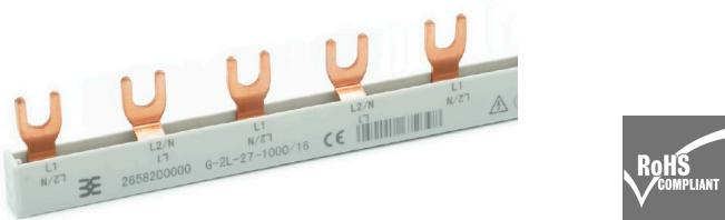
2-контактные фазовые распределительные шины вилочного типа используются для распределения потенциалов между другими компонентами распределительного шкафа, такими как автоматы защиты цепи, автоматы защиты цепи остаточного тока и другие установочные устройства.
