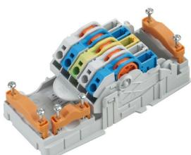
Распределение электроэнергии с использованием необработанных кабелей сечением от 1,5 до 6 мм<sup>2</sup>. Подача электропитания/T-образный отвод посредством соединения PUSH IN (0,5-10 мм<sup>2</sup>) и/или вставное соединение (0,5-4 мм<sup>2</sup>). Цветная маркировка обеспечивает четкое распределение проводов.
