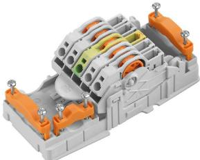
Распределение электроэнергии с использованием необработанных кабелей сечением от 1,5 до 6 мм<sup>2</sup>. Подача электропитания/Т-образный отвод посредством соединения PUSH IN (0,5-10 мм<sup>2</sup>) и/или вставное соединение (0,5-4 мм<sup>2</sup>). Цветная маркировка обеспечивает четкое распределение проводов.
