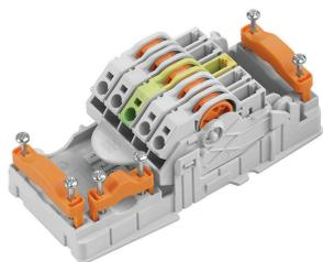
Распределение электроэнергии с использованием необработанных кабелей сечением от 1,5 до 6 мм<sup>2</sup>. Подача электропитания/Т-образный отвод посредством соединения PUSH IN (0,5-10 мм<sup>2</sup>) и/или вставное соединение (0,5-4 мм<sup>2</sup>).
