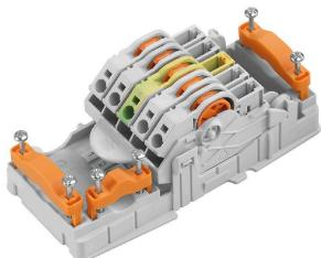
Распределение электроэнергии с использованием необработанных кабелей сечением от 1,5 до 6 мм<sup>2</sup>. Подача электропитания/T-образный отвод посредством соединения PUSH IN (0,5-10 мм<sup>2</sup>) и/или вставное соединение (0,5-4 мм<sup>2</sup>).
