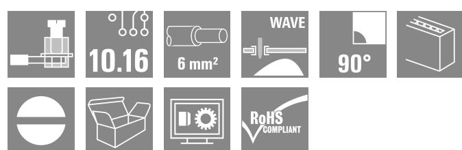
Клемма для печатной платы с проверенным на практике винтовым соединением с шагом 10 и 10,16 мм и направлением вывода проводов под углом 90°. Для проводов сечением до 6,0  $\text{mm}^2$ .
