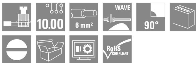
Клемма для печатной платы с проверенным на практике винтовым соединением с шагом 10 и 10,16 мм и направлением вывода проводов под углом 90°. Для проводов сечением до 6,0 мм<sup>2</sup>.
