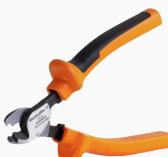
Режущие инструменты для проводников наружным диаметром до 8, 12, 14 и 22 мм. Особая геометрия лезвия обеспечивает резку медных и алюминиевых проводников без пережатия и с минимальным физическим усилием. Режущие инструменты (от KT 8 до KT 22) также поставляются с защитной изоляцией до 1000 В, прошедшей испытания VDE и GS, в соответствии со стандартом EN/ IEC 60900.
