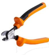
Режущие инструменты для проводников наружным диаметром до 8, 12, 14 и 22 мм. Особая геометрия лезвия обеспечивает резку медных и алюминиевых проводников без пережатия и с минимальным физическим усилием. Режущие инструменты (от KT 8 до KT 22) также поставляются с защитной изоляцией до 1000 В, прошедшей испытания VDE и GS, в соответствии со стандартом EN/ IEC 60900.
