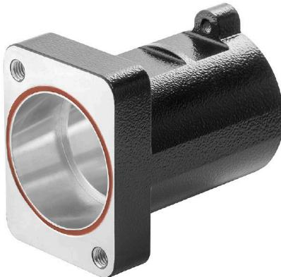
Защитный корпус изготовлен из стойкого к морской воде алюминия методом литья под давлением. Высокие стандарты водо- и пылезащиты, а также чрезвычайно высокая ударостойкость являются отличительными признаками корпусов данной серии. Современное двухэтапное покрытие поверхности обеспечивает многолетнюю надежность. Все винты, обжимные контакты и другие наружные детали принадлежностей изготовлены из коррозионностойкой нержавеющей стали.
