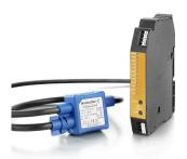
Пояс РоговскогоПояс Роговского — это закрытая воздушная катушка без ферромагнитного сердечника, используемая для измерения плавающего потенциала переменного и импульсного тока. Измерение с помощью пояса Раговского широко используется в технике, так как оно может быть интегрировано без разделения первичной электрической цепи в существующих системах. Поскольку этот метод не подвержен эффекту насыщения, даже самые маленькие токи и высокочастотные гармоники могут быть измерены без потери точности.
