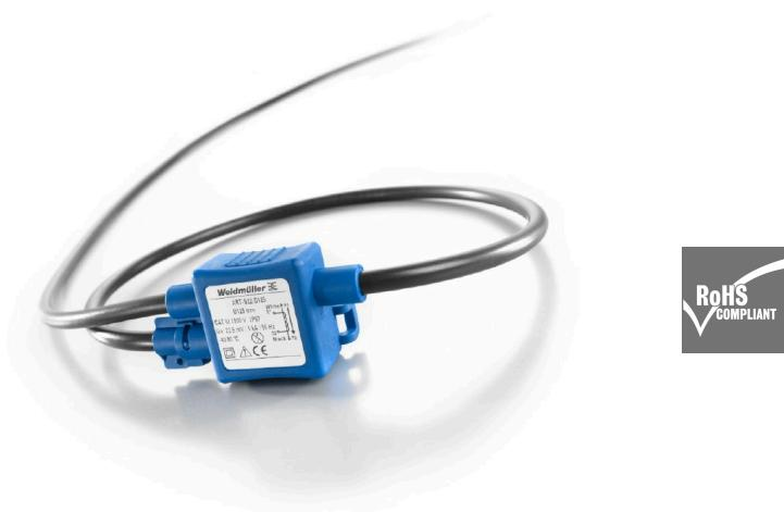
Пояс Роговского Пояс Роговского — это закрытая воздушная катушка без ферромагнитного сердечника, используемая для измерения плавающего потенциала переменного и импульсного тока. Измерение с помощью пояса Роговского широко используется в технике, так как оно может быть интегрировано без разделения первичной электрической цепи в существующих системах. Поскольку этот метод не подвержен эффекту насыщения, даже самые маленькие токи и высокочастотные гармоники могут быть измерены без потери точности.
