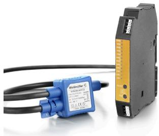
Пояс Роговского Пояс Роговского — это закрытая воздушная катушка без ферромагнитного сердечника, используемая для измерения плавающего потенциала переменного и импульсного тока. Измерение с помощью пояса Роговского широко используется в технике, так как оно может быть интегрировано без разделения первичной электрической цепи в существующих системах. Поскольку этот метод не подвержен эффекту насыщения, даже самые маленькие токи и высокочастотные гармоники могут быть измерены без потери точности.
