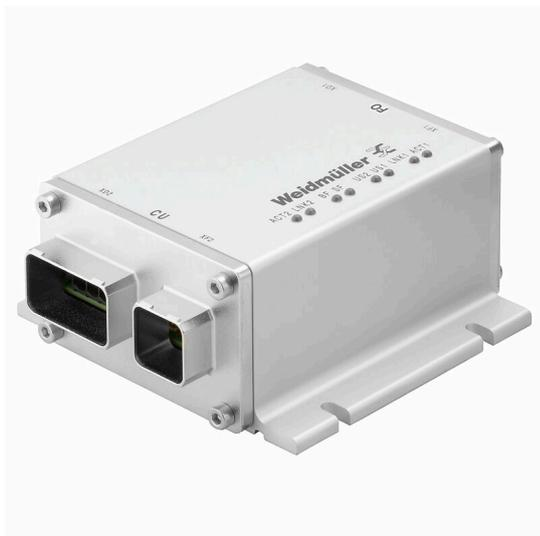
Медиа-конвертер FreeCon Active PROFINET с функциями диагностики, для вставного разъема PushPull вар. 14 по стандарту IEC 61076-3-117 с RJ45 и SC-RJ POF по стандарту IEC 61754-24 и PushPull Power по спецификации PROFINET.
