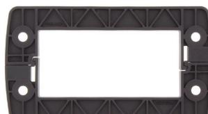
Рамка, изготовленная из одной детали, быстро и легко собирается и состоит из размерно стабильного и армированного стекловолокном пластика. Стягивающее уплотнение из пеноматериала гарантирует эффективное уплотнение класса IP66 в соответствии с DIN EN 60529 даже на окрашенных и шероховатых поверхностях.
