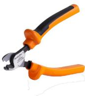
Режущие инструменты для проводников наружным диаметром до 8, 12, 14 и 22 мм. Особая геометрия лезвия обеспечивает резку медных и алюминиевых проводников без пережатия и с минимальным физическим усилием. Режущие инструменты (от КТ 8 до КТ 22) также поставляются с защитной изоляцией до 1000 В, прошедшей испытания VDE и GS, в соответствии со стандартом EN/ IEC 60900.
