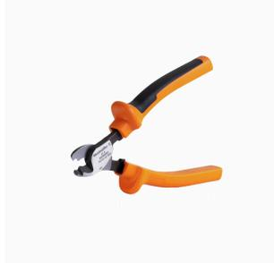
Режущие инструменты для проводников наружным диаметром до 8, 12, 14 и 22 мм. Особая геометрия лезвия обеспечивает резку медных и алюминиевых проводников без пережата и с минимальным физическим усилием. Режущие инструменты (от КТ 8 до КТ 22) также поставляются с защитной изоляцией до 1000 В, прошедшей испытания VDE и GS, в соответствии со стандартом EN/ IEC 60900.
