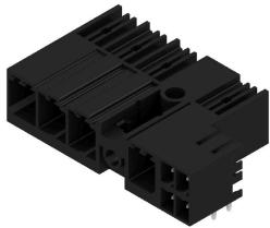
Комбинированный штекерный соединитель 90° с силовыми и сигнальными контактами с технологией соединения PUSH IN, включая самоблокирующий замок среднего фланца и (дополнительный вариант) разъемное подключение экрана с шагом 7,62. Позволяет одновременно подсоединять напряжение, сигналы и (дополнительно) экран EMC. Отличное решение для подключения сервоприводов и асинхронных приводов.
