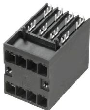
Двухрядный сильноточный, с хорошими эксплуатационными характеристиками штыревой разъем, с фланцем или без него, для быстрой фиксации без инструмента. Оптимизирован для модулей «книжного формата» шириной 50 mm и более. С встроенным вариантом монтажа на стенке корпуса. Исключительная надежность и эксплуатационная безопасность благодаря 100% отказоустойчивости сопрягающихся профилей, уникальной кодировке и дополнительно заказываемому креплению на винтах во фланце.
