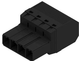
Перевернутый штекерный соединитель 180° с технологией соединений PUSH IN для проводов сечением 6 мм<sup>2</sup> с шагом 7,62 в качестве "трехфланцевого варианта" для сквозных соединений в корпусе. Подходит для корпусов с макс. толщиной стенки 2 мм. Также является превосходным решением с защитой от прикосновения для обратных напряжений. Соответствие требованиям стандартов UL1059 600 V, класс C, IEC 61800-5-1.
