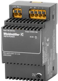
Однофазные импульсные источники питания INSTA-POWER характеризуются широким диапазоном мощностей, компактной конструкцией и хорошим соотношением цены и качества. Они предназначенные для диапазона температур от -25 до 70 °C, имеют международные сертификаты и широкий диапазон входных напряжений. Это делает их подходящими для многих областей применения. Сюда также входят сигнальные и телекоммуникационные системы, а также системы автоматизации с низким энергопотреблением до 96 Вт.
