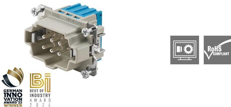
При использовании быстроразъемного соединения SNAP IN уровень соединения проводов уже открыт, и можно просто вставить очищенный провод. В конечном положении запатентованный фиксирующий механизм закроется автоматически. Благодаря этому техническое обслуживание практически не требуется, и обеспечивается безопасное, долговременное и защищенное от вибрации соединение. Таким образом, компания Weidmüller является первым и единственным производителем, предлагающим эту инновационную систему соединений.
