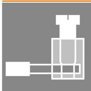
Вставной разъем M12 в IP 67 доступен с винтовым или пружинным соединением
