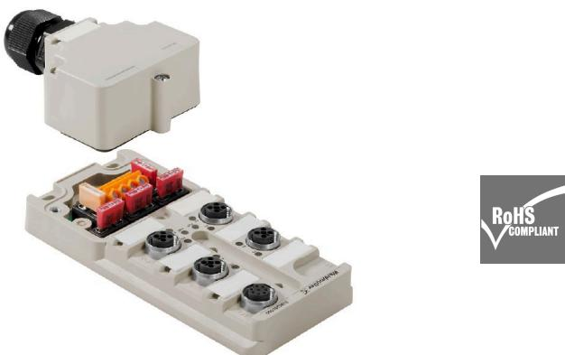
4-канальный распределитель питания SAI с двойной полярностью и гальванически развязанным сигналом обратного контроля через 8-конт. разъем M12.
