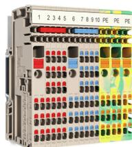
Уникальная модульная концепция может быть адаптирована к любому типу оборудования. Клеммы распределения потенциалов AAP успешны благодаря унифицированному дизайну и двум возможным конструкциям — однополюсной или двухполюсной. В сгруппированной структуре распределения управляющего напряжения потенциалы расположены на разных клеммных колодках и образуют таким образом целые потенциальные блоки.
