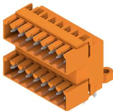
Двухуровневый штекерный соединитель для пайки волной припоя с шагом 3,50 мм. Варианты исполнения соединителя: открытый, закрытый и с фланцем. Штекерные разъемы обеспечивают место для маркировки и допускают кодирование. Упаковка — картонная коробка.
