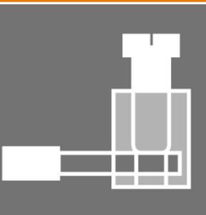
Вставной разъем M12 в IP 67 доступен с винтовым или пружинным соединением
