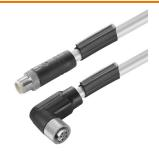
Вашим периферийным устройствам требуется питание большей мощности. С нашим новым вставным разъемом М12 можно обеспечить питание более 250 В и 2 А без всяких проблем. Компактные вставные разъемы М12 с А-, К-, L-, S- и Т-кодировкой предназначены для передачи напряжения до 630 В перем. тока или 60 В пост. тока при силе тока до 12 А.
