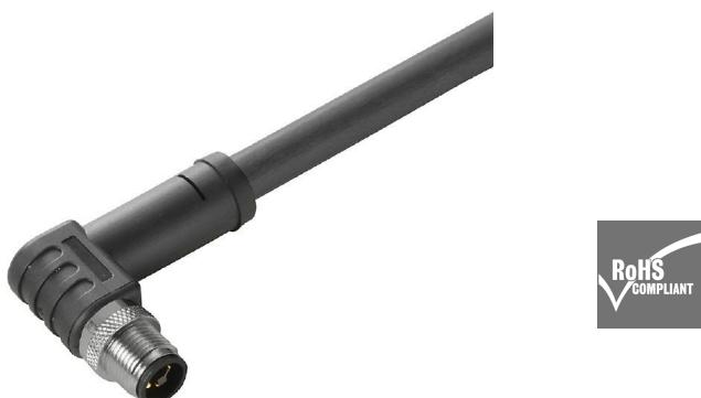
Вашим периферийным устройствам требуется питание большей мощности. С нашим новым вставным разъемом M12 можно обеспечить питание более 250 В и 2 А без всяких проблем. Компактные вставные разъемы M12 с A-, K-, L-, S- и T-кодировкой предназначены для передачи напряжения до 630 В перем. тока или 60 В пост. тока при силе тока до 12 А.
