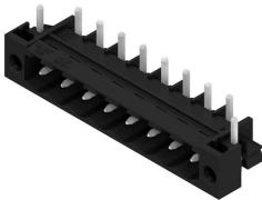
Термостойкий открытый штекерный соединитель прямой конфигурации. Упаковка — коробка или лента. На ленте и с выводами под пайку 1,5 mm оптимизирован для автоматического монтажа. Длина выводов 3,2 mm подходит для пайки волной припоя и оплавлением сквозных отверстий (Reflow). Штекерные соединители обеспечивают место для маркировки и допускают кодирование. HC = сильноточный.
