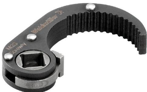
Принадлежность Screwty® подходит для цилиндрических вставных разъемов M23 (для сборки заказчиком) и литых с повторным формированием цилиндрических вставных разъемов M23 с наружным размером гайки с накаткой  $26,2 \pm 0,3$  мм. Момент затяжки составляет 2–2,5 Нм.
