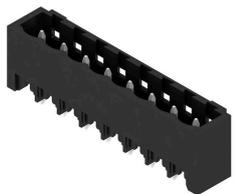
Термостойкий штекерный соединитель, упаковка — коробка или лента. На ленте и с выводами под пайку 1,5 мм оптимизирован для автоматического монтажа. Длина выводов 3,2 мм подходит для пайки волной припоя и оплавлением сквозных отверстий (Reflow). Штекерные соединители обеспечивают место для маркировки и допускают кодирование. HC = высокоточный.
