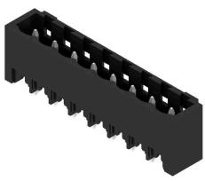
Термостойкий штекерный соединитель, упаковка — коробка или лента. На ленте и с выводами под пайку 1,5 mm оптимизирован для автоматического монтажа. Длина выводов 3,2 mm подходит для пайки волной припоя и оплавлением сквозных отверстий (Reflow). Штекерные соединители обеспечивают место для маркировки и допускают кодирование. HC = сильноточный.
