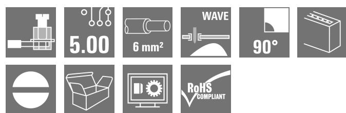
Многорядные клеммы для печатных плат с проверенным на практике винтовым соединением и шагом 5,00 и 5,08 мм. Направление вывода проводов: 90°. Для проводов сечением до 6,0 мм<sup>2</sup>.
