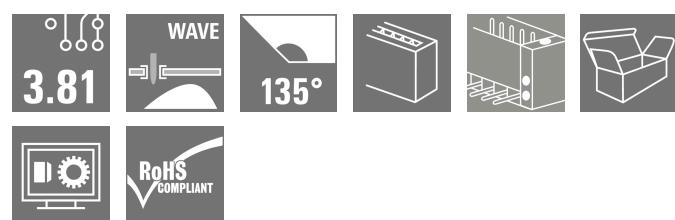
Вилочный разъем SC с направлением вывода 135° - угол 135° определяется между направлением вставки и контактным штырьком и означает угол вывода относительно печатной платы 45°.
