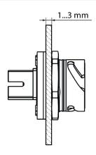
Толщина стенки при использовании центрального винтового соединения
