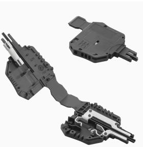
Держатель предохранителя SIHA в мгновение ока превращает клемму с размыкателем в клемму с предохранителем: просто удалите размыкающий рычажок и установите вилку предохранителя.
