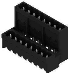
Термостойкий, двухуровневый, с боковым смещением, вилочный разъем в закрытом исполнении, фланец под пайку в качестве опции. Контактные штифты длиной 1,5 mm пригодны для пайки по технологии Reflow. Контактные штырьки длиной 3,2 mm пригодны для пайки по технологии Reflow и пайки волной. Разъемы снабжены местом для маркировки, а также они могут быть кодированы.
