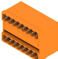
Двухуровневый вилочный разъем с параллельным разъемом. Длина контактного штырька оптимизирована под пайку волной. Разъемы снабжены местом для маркировки, а также они могут быть кодированы.
