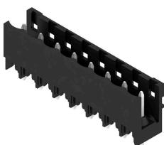
Термостойкий открытый штекерный соединитель прямой конфигурации. Упаковка — коробка или лента. На ленте и с выводами под пайку 1,5 mm оптимизирован для автоматического монтажа. Длина выводов 3,2 mm подходит для пайки волной припоя и оплавлением сквозных отверстий (Reflow). Штекерные соединители обеспечивают место для маркировки и допускают кодирование. HC = сильноточный.
