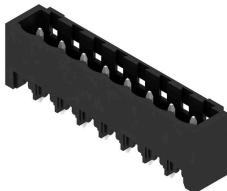
Термостойкий штекерный соединитель, упаковка — коробка или лента. На ленте и с выводами под пайку 1,5 мм оптимизирован для автоматического монтажа. Длина выводов 3,2 мм подходит для пайки волной припоя и оплавлением сквозных отверстий (Reflow). Штекерные соединители обеспечивают место для маркировки и допускают кодирование. HC = сильноточный.
