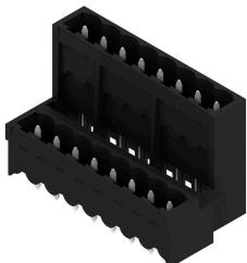
Термостойкий, двухуровневый, с боковым смещением, вилочный разъем в закрытом исполнении, фланец под пайку в качестве опции. Контактные штифты длиной 1,5 мм пригодны для пайки по технологии Reflow. Контактные штырьки длиной 3,2 мм пригодны для пайки по технологии Reflow и пайки волной. Разъемы снабжены местом для маркировки, а также они могут быть кодированы.
