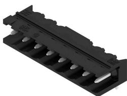
Термостойкий открытый штекерный соединитель угловой конфигурации (90°). Упаковка — коробка или лента. На ленте и с выводами под пайку 1,5 mm оптимизирован для автоматического монтажа. Длина выводов 3,2 mm подходит для пайки волной припоя и оплавлением сквозных отверстий (Reflow). Штекерные соединители обеспечивают место для маркировки и допускают кодирование. HC = сильноточный.
