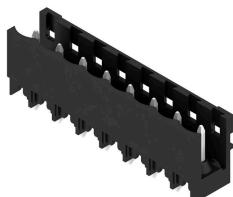
Термостойкий открытый штекерный соединитель прямой конфигурации. Упаковка — коробка или лента. На ленте с выводами под пайку 1,5 mm оптимизирован для автоматического монтажа. Длина выводов 3,2 mm подходит для пайки волной припоя и оплавлением сквозных отверстий (Reflow). Штекерные соединители обеспечивают место для маркировки и допускают кодирование. HC = сильноточный.
