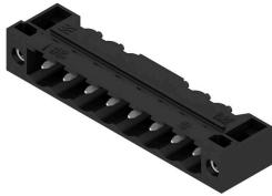
Термостойкий штекерный соединитель, упаковка — коробка или лента. На ленте и с выводами под пайку 1,5 mm оптимизирован для автоматического монтажа. Длина выводов 3,2 mm подходит для пайки волной припоя и оплавлением сквозных отверстий (Reflow). Штекерные соединители обеспечивают место для маркировки и допускают кодирование. HC = сильноточный.
