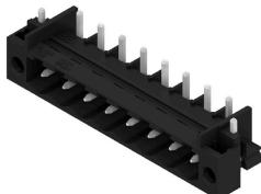
Термостойкий открытый штекерный соединитель прямой конфигурации. Упаковка — коробка или лента. На ленте и с выводами под пайку 1,5 мм оптимизирован для автоматического монтажа. Длина выводов 3,2 мм подходит для пайки волной припоя и оплавлением сквозных отверстий (Reflow). Штекерные соединители обеспечивают место для маркировки и допускают кодирование. HC = сильноточный.
