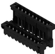
Термостойкий, двухуровневый, с боковым смещением, вилочный разъем с фланцем или фланцем под пайку. Контактные штифты длиной 1,5 mm пригодны для пайки по технологии Reflow. Контактные штырьки длиной 3,2 mm пригодны для пайки по технологии Reflow и пайки волной. Разъемы снабжены местом для маркировки, а также они могут быть кодированы.
