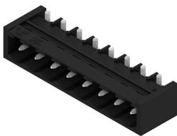
Термостойкий открытый штекерный соединитель прямой конфигурации. Упаковка — коробка или лента. На ленте и с выводами под пайку 1,5 мм оптимизирован для автоматического монтажа. Длина выводов 3,2 мм подходит для пайки волной припоя и оплавлением сквозных отверстий (Reflow). Штекерные соединители обеспечивают место для маркировки и допускают кодирование. HC = высокоточный.
