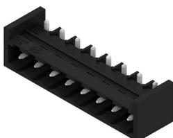
Термостойкий открытый штекерный соединитель прямой конфигурации. Упаковка — коробка или лента. На ленте и с выводами под пайку 1,5 мм оптимизирован для автоматического монтажа. Длина выводов 3,2 мм подходит для пайки волной припоя и оплавлением сквозных отверстий (Reflow). Штекерные соединители обеспечивают место для маркировки и допускают кодирование. HC = высокоточный.
